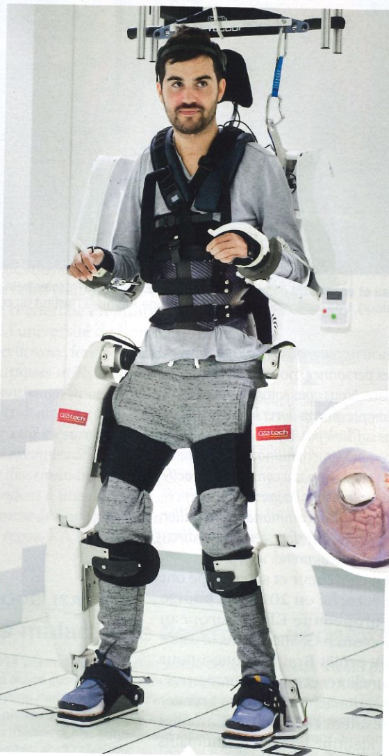
La neuroprothèse de Clinatec (à droite), implantée dans la boîte crânienne, a permis à un tétraplégique de marcher, en contrôlant par son cerveau un exosquelette.
